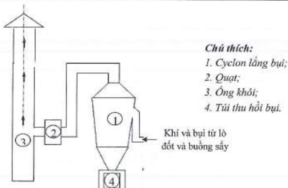
Hình 4.3. Hệ thống lọc bụi lò sấy
